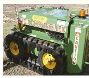
El cargador puede detectar bajo nivel de aceite y calor excesivo. Por lo tanto, se apagará inmediatamente para proteger el motor.
