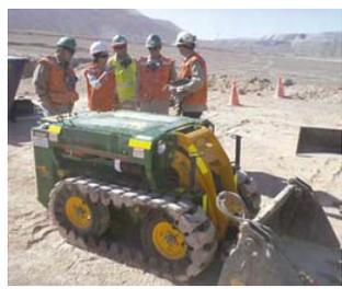
El minicargador de control remoto resiste ambientes altamente corrosivos como el mineral de hierro, sal, cobre o polvo rojo. El recubrimiento de zinc protegerá la cadena contra el agarrotamiento o la oxidación.
